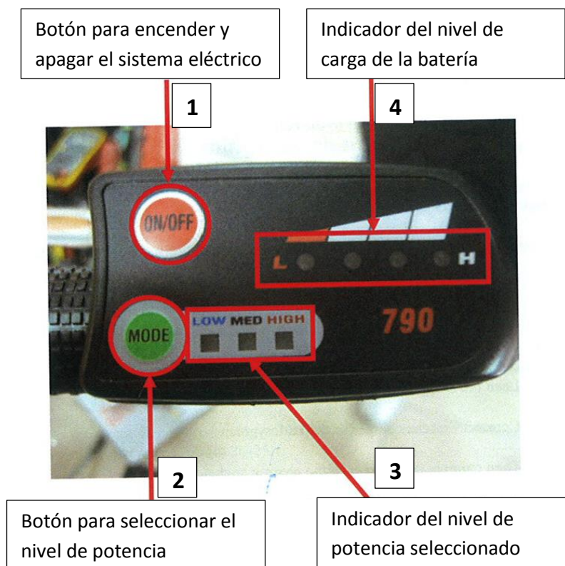
Ilustración 5. Mando para el control del sistema eléctrico de la batería, ubicado en el manillar
