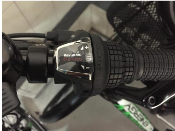
Ilustración 13. Puño derecho del manillar de la bici para el cambio de piñones
