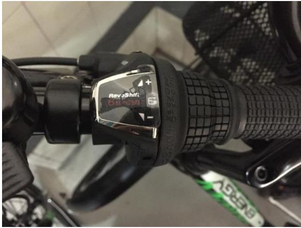
Ilustración 6. Puño derecho del manillar de la bici para cambio de piñones
