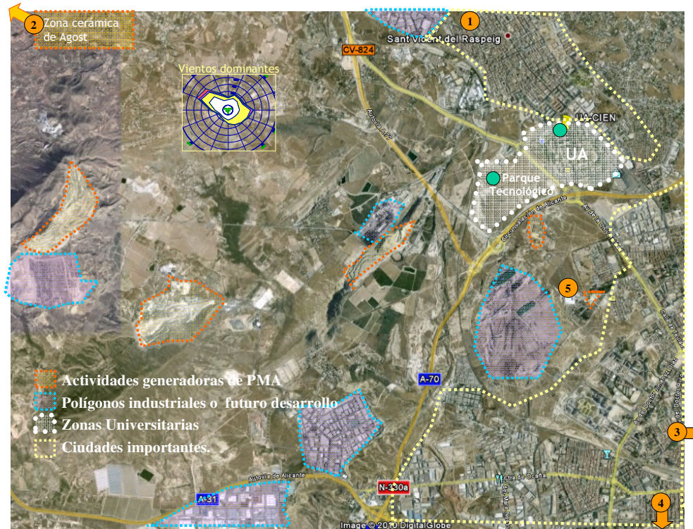
Figura 1: Localización de la Universidad de Alicante y zona de desarrollo del Parque Científico de Alicante. Principales actividades que pueden afectar a la calidad del aire del entorno más próximo. Ubicación de las estaciones de muestreo, tanto las pertenecientes a este proyecto (verde) como las pertenecientes a la red de vigilancia de la calidad del aire de la Generalitat Valenciana (naranja).
