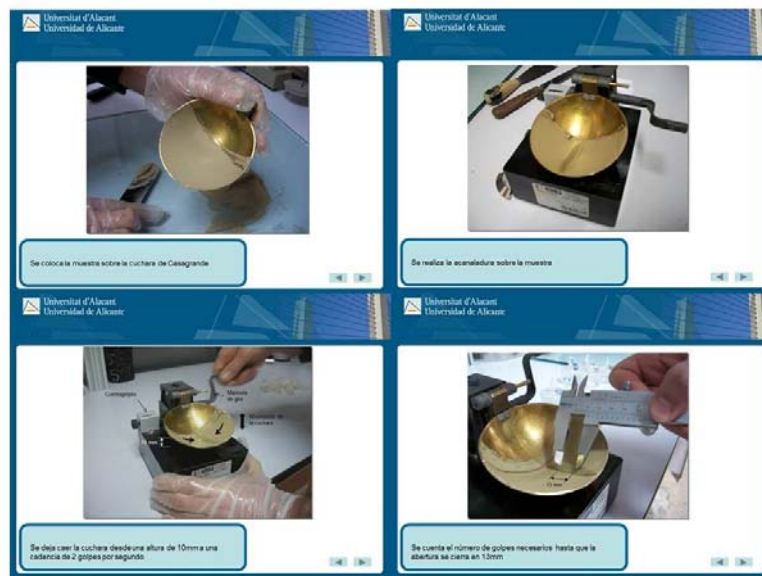
Figura 4. Secuencia parcial del procedimiento de determinación del límite líquido de un suelo por el procedimiento de la cuchara de Casagrande.
