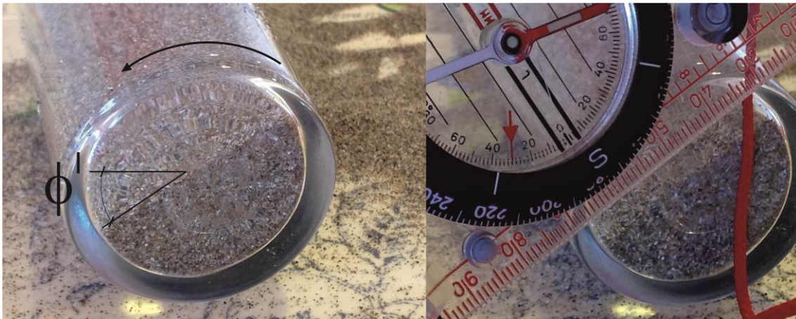
Figura 3. Determinación del ángulo de rozamiento efectivo de una arena seca ( \phi' \cong 30^\circ ). Obsérvese que el ángulo es medido con el clinómetro de una brújula de geólogo.
