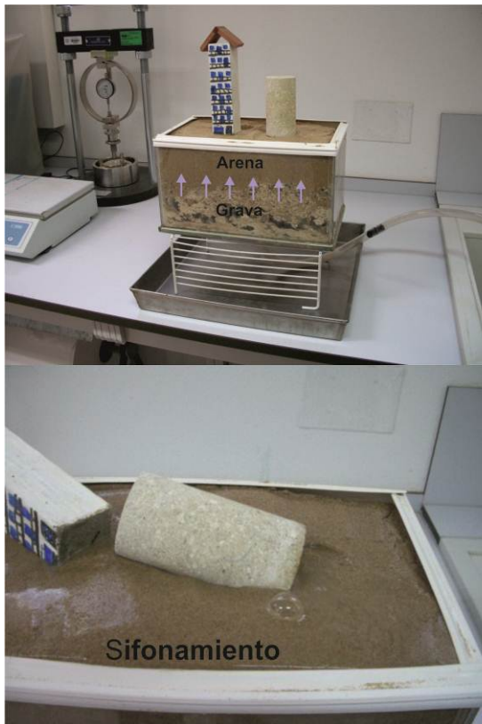
Figura 4. Experimento para simular el fenómeno de sifonamiento en arenas por efecto de un flujo de agua ascendente. A la izquierda se muestra el equipo casero realizado mientras que a la derecha se esquematiza la justificación geotécnica del fenómeno.
