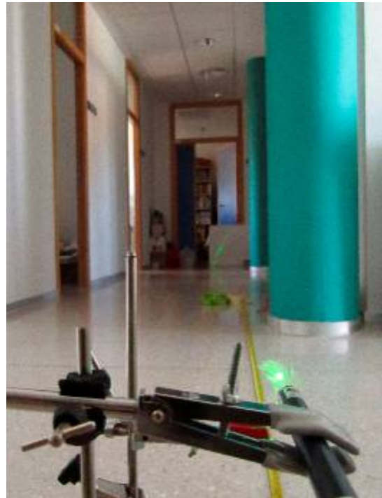
Figura 1. (Izq.) En la representación esquemática del montaje experimental se indica la distancia L entre la pluma y la pantalla, así como la separación h entre los diversos puntos luminosos y el punto central del patrón de difracción. (Der.) El montaje experimental para la difracción de la luz de un láser a través de una pluma de ave estaba formado por los siguientes materiales: soportes, puntero láser, pluma (de pato, recogida en un estanque), cinta métrica y pantalla; sobre el suelo del pasillo se aprecia la cinta métrica usada para medir la distancia entre la pluma y el patrón de difracción, que se forma en la pantalla situada al fondo de la imagen.
