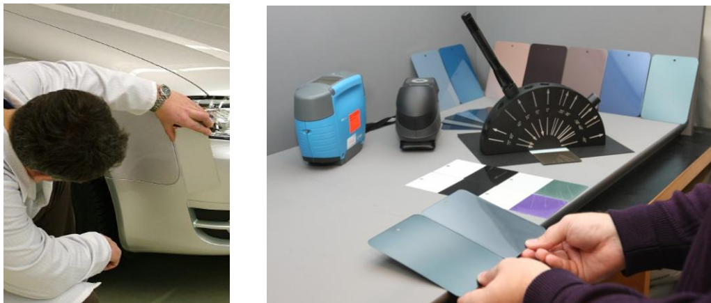
Figura 6: Ejemplo de desarmonía de color en la parte frontal de un coche (izquierda). Comparación visual (color, brillo y textura) de un par de muestras dentro de una cabina de iluminación (derecha).
