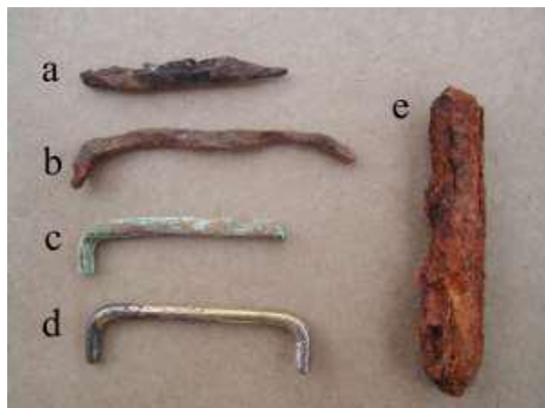
Figura 3. Cemitério Nossa Senhora do Carmo. Gatos e cavilha de ferro (a, b, e): Ca. 1897. Gatos de cobre (c, d): Ca. 1901.
