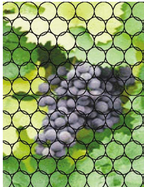
Fig. 1. Ejemplo de muestreo espacial con una red de fotorreceptores separados \Delta d (frecuencia de muestreo 1/\Delta d ).
